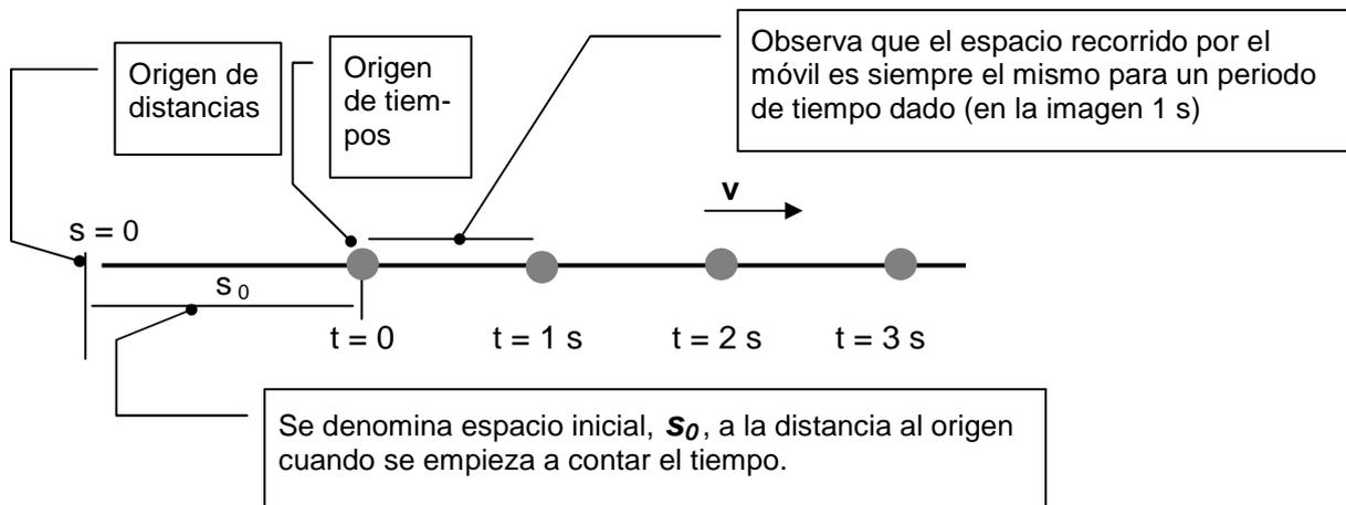
**La gráfica  $s/t$  es una línea recta. La inclinación (pendiente) nos da la velocidad. El punto de corte con el eje vertical da  $s_0$**
